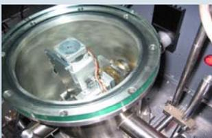
X-Y-Z micro-illumination VUV stage-chamber
